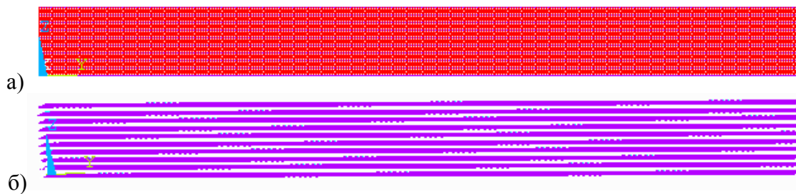
Рисунок 2. Расчетная модель для системы слоев (а – показаны все взаимодействия, б – показаны только взаимодействия в слоях)
