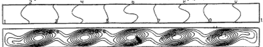
Рис. 2. Изотермы (вверху) и изолинии функции тока (внизу) при Ra=2 \cdot 10^5 , Pr= 5.8 , L/H=12.71 , (\partial T/\partial y|_{y=0, H=0} = 0)
