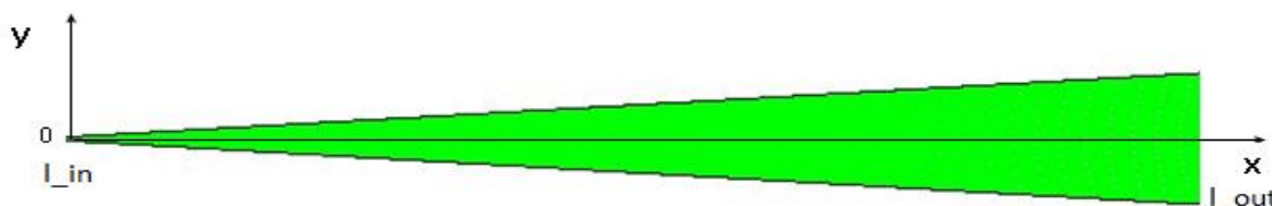
Рис. 12. Схема расчетной области и сетка для плоского диффузора с углом раствора \beta = 4^\circ и длиной 0.495 метра
