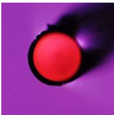
Рис. 3. Срез оптоволоконного лазерного диода под микроскопом.
